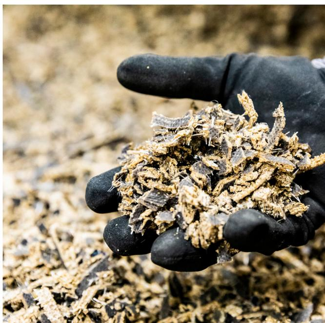
*Sous-couche EcoBase séparée de la dalle de moquette et recyclée pour la production de nouvelle sous-couche*
